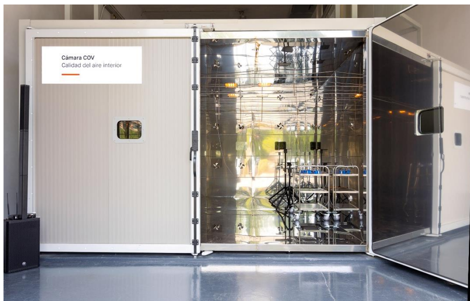
Figura 1.- Cámara climática de 60 m 3 .
