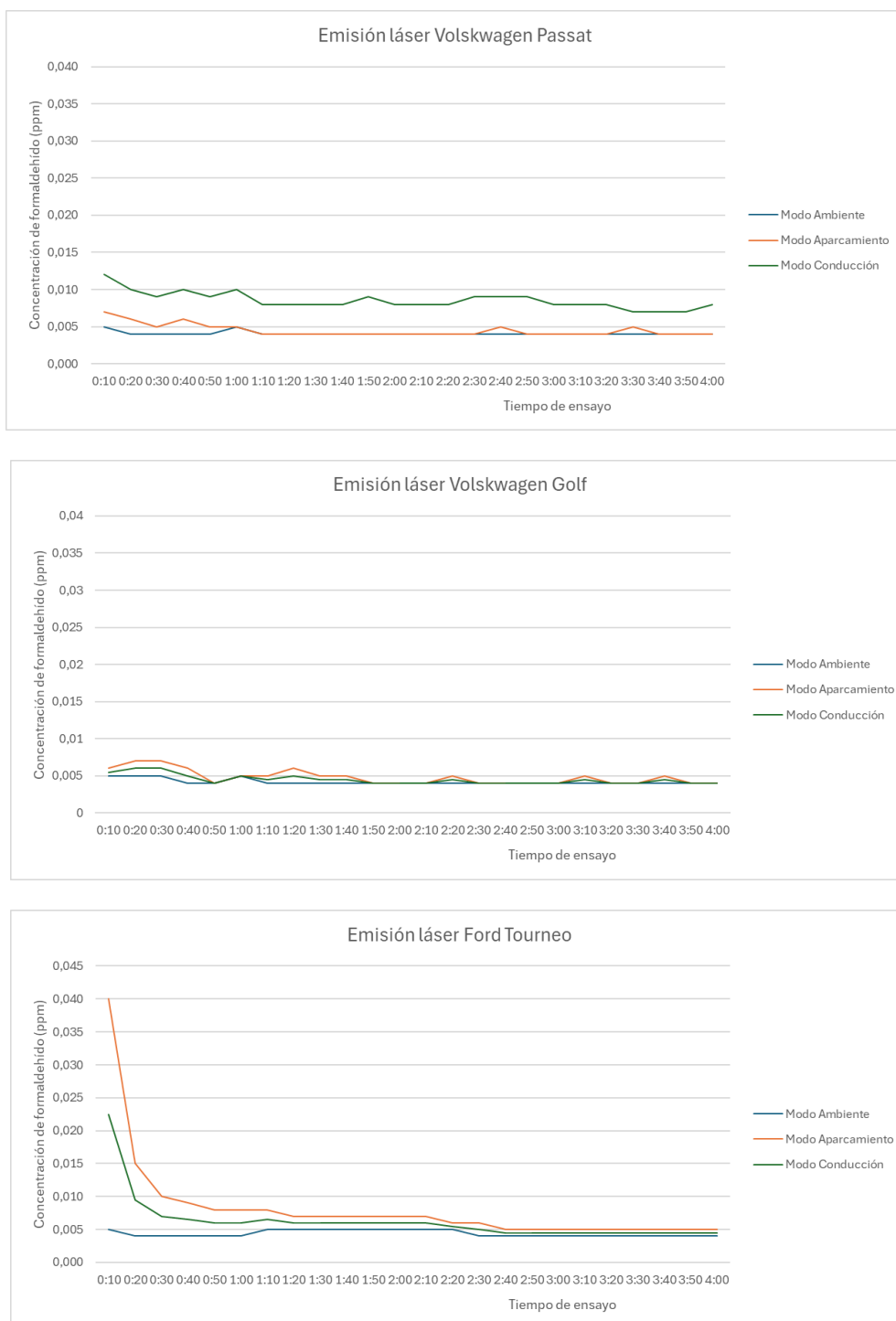
Figura 17.- Resultados de emisión de formaldehído mediante el método por láser.
